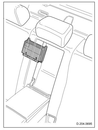
Fig. 5 Air suspension module
