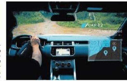
**СИСТЕМА ОБМЕНА ИНФОРМАЦИЕЙ МЕЖДУ АВТОМОБИЛЯМИ ПРИ ДВИЖЕНИИ КОЛОННОЙ ПО БЕЗДОРОЖЬЮ (OFF-ROAD CONNECTED CONVOY)**
