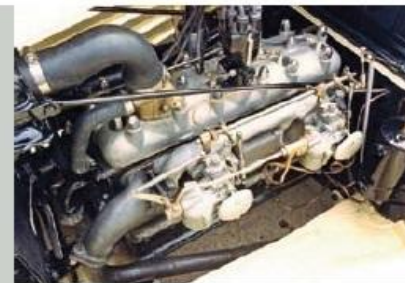
Шестичилиндровый двигатель Airline (либо 2143 куб. см, либо 2663 куб см) с трудом справлялся с автомобилем массой 2700 кг. Карбюратор RAG вызывал много вопросов и владельцы SS1 часто меняли его на SU.
